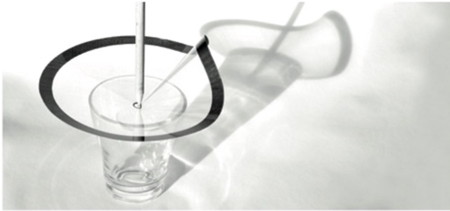
Un D-cône, l'une des singularités qui peuplent le papier froissé, peut être obtenu en appuyant une feuille dans un verre. (Cliché C. Audoly)
